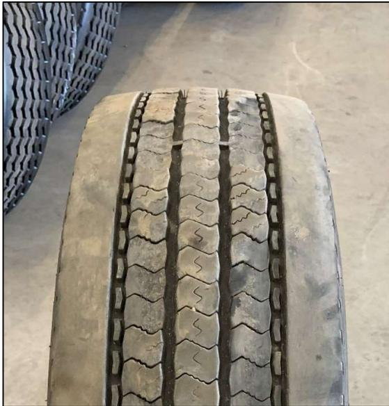
**11. Irregular Wear (Неравномерный износ протектора).**
