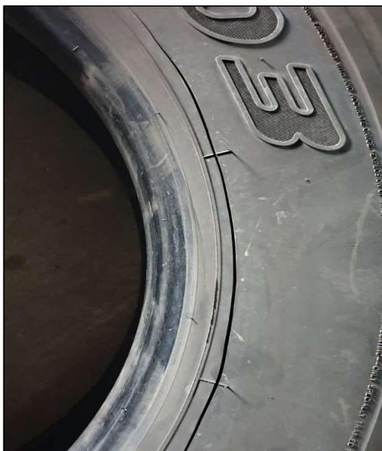
**10. Sidewall separation (Расслоение по боковине) –** Расслоения, начинающиеся после перехода от бортового кольца к боковине. Продолговатое расслоение без неровностей и без изломов кордов. В данном случае поврежден только внешний слой резины из-за образования стыка под стенкой резины.
