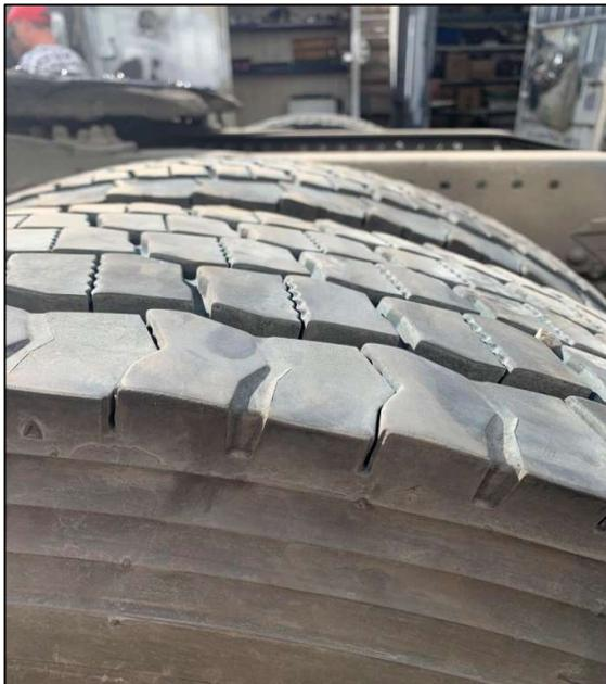
**4. N&T (Heel & Toe Wear) (Гребенчатый/ Пилообразный износ)**
