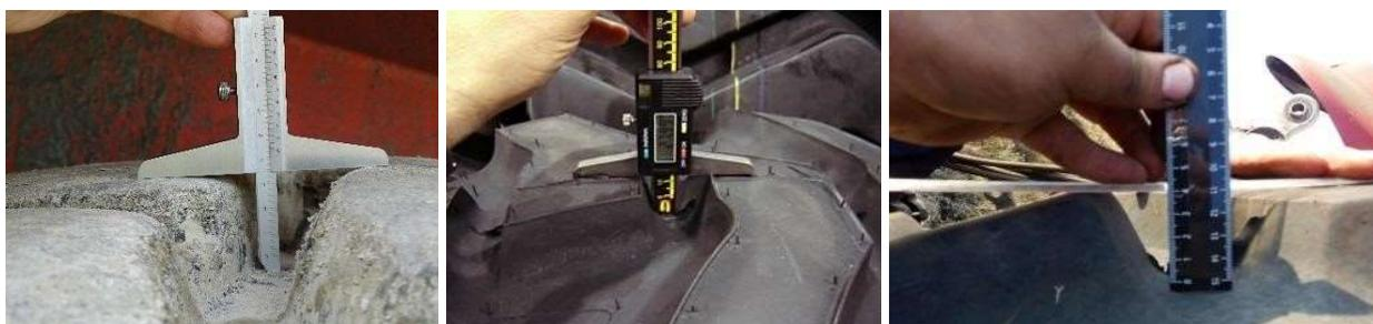
Показания глубиномера (штангенциркуля или линейки) должны быть разборчивые. Для замера щуп глубиномера (штангенциркуля) или линейка устанавливается в индикатор износа шины или рядом с ним в зависимости от его формы.
