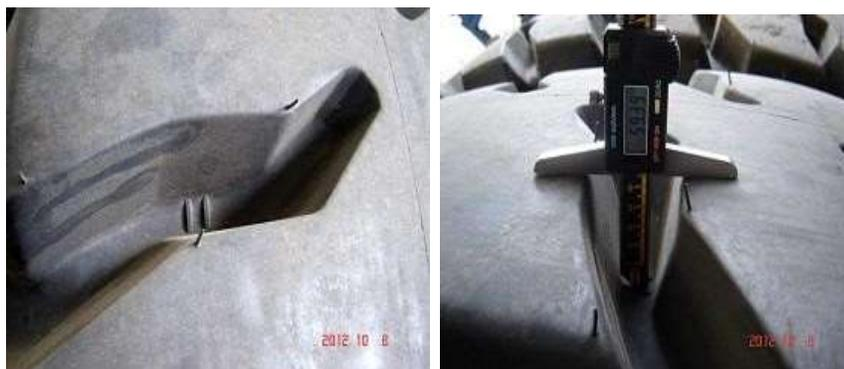
Индикатор износа большинства шин находится в канавке протектора в обеих плечевых зонах шины на внешней и внутренней стороне.
