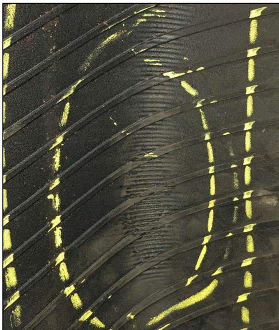
**1. Inner Liner Splice (Выступ нитей по гермослою) -** выступ (просвечивание) нитей корда из-под гермослоя, обнажающийся локально, чаще всего появляются на внутренней плечевой области. Также за счёт данного дефекта могут образовываться вздутия на наружной плечевой зоне с возможным последующим взрывом.
